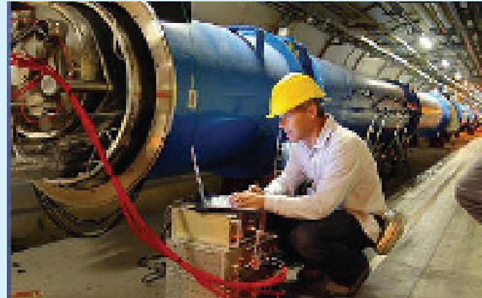
この青いパイプは、膨大なエネルギーを生み出すための加速器で、一周 27km ある。この中で陽子を両側から光に近い速さまで加速し、正面衝突させ様々な素粒子をはじき出す。衝突によってビッグバンに匹敵する膨大なエネルギーが小規模に発生する。この加速器は地下で全長 27 km の輪になっているため、超高速で移動する陽子を、円形にまわるようにコントロールする強力な磁力が必要である。6000 本の銅線を直径 8mm にまとめたものが大量に必要。1 m の銅の筒を 40km に伸ばして作る。この銅線製作は日本の金属メーカーが請け負った。
