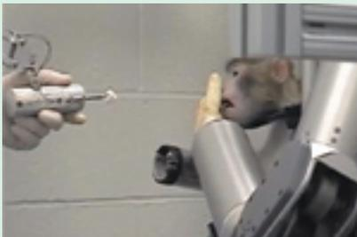
ピッツバーグ大学の研究で、猿が、体外にそなえたロボットアームを考えるだけで操作することに成功した。脳に電極を埋め込んでロボットアームとつなぎ自分の手のように動かす。かなり精密な動作が可能になり、3週間のトレーニングで、食べものを口に運ぶことができるように
