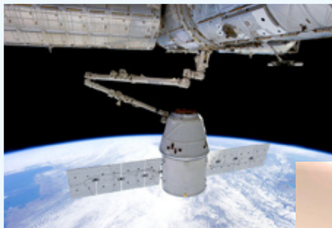
国際宇宙ステーションに、カナダアームがSpaceXの貨物宇宙船ドラゴン号をドッキングさせているところ。
