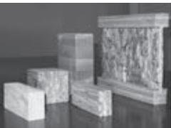
エンジニアード・ウッドの素材(左からLVL、LSL(2個)GLT、I-Beam)
