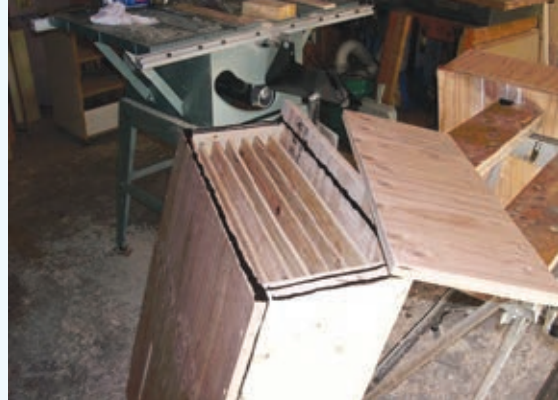
巣箱の内部の8列の室が見える、天井取り付け前の写真。
