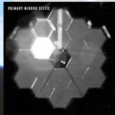
システム調整のために内部に設置された瞳孔像レンズでウェブ宇宙望遠鏡が撮影した自撮り写真。
